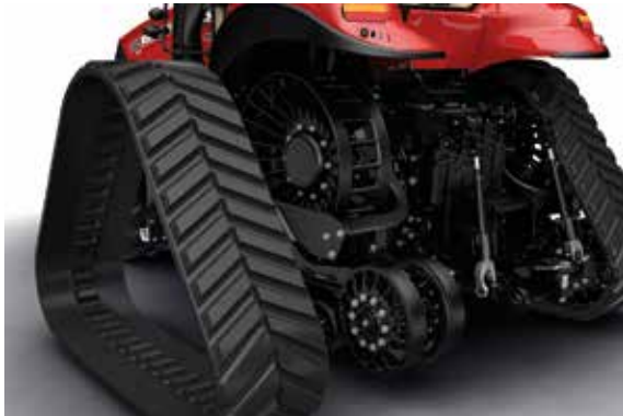
Het positieve aandrijfsysteem elimineert onder alle omstandigheden slippen van het aandrijf wiel en de rubber rupsband.
