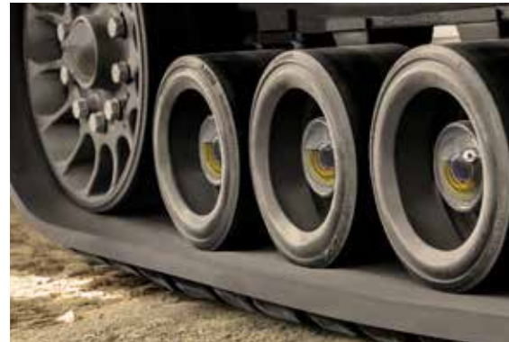
Oliepeilglazen in de wielnaven vereenvoudigen dagelijkse inspecties.
